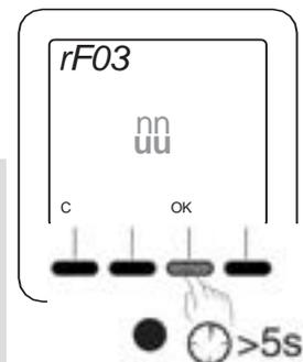
Springt die Anzeige nicht wieder auf 00 zurück, bedeutet dies, dass einige Empfänger nicht auf Befehle reagieren.
